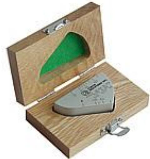
Blocco campione n°2 secondo UNI EN 27963
