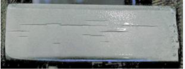
POLVERE NERA IN KEROSENOIL E LACCA DI CONTRASTO
