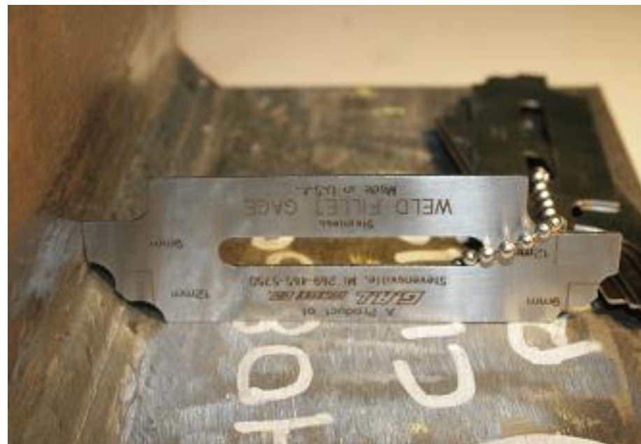
Controllo di un giunto d'angolo con weld fillet gauge o "scarsetta"
