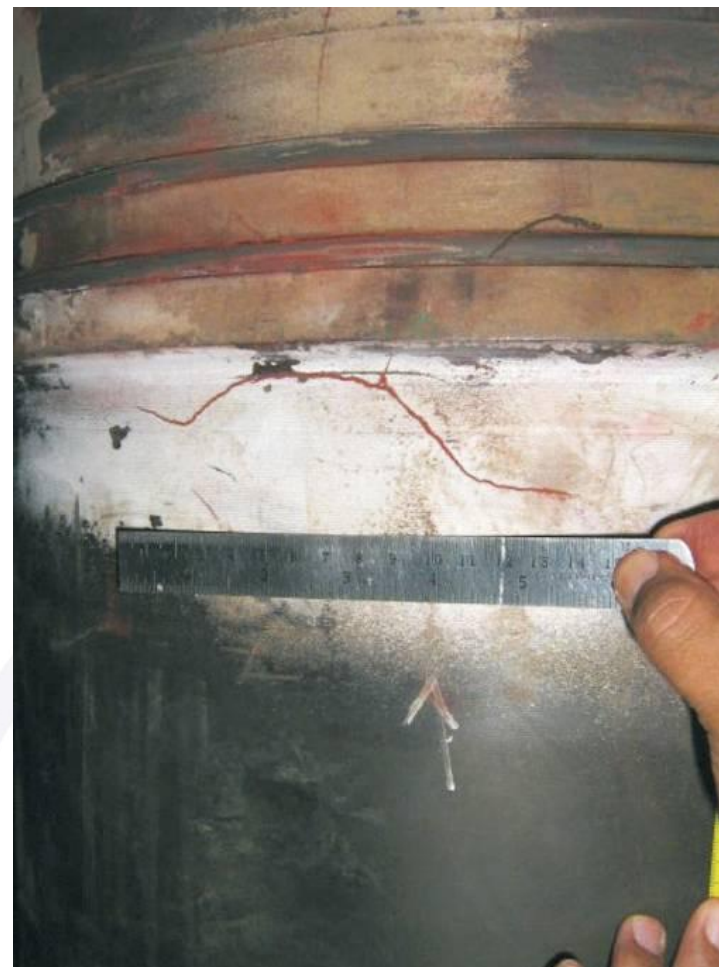
Rivelatore secco, a contrasto di colore
