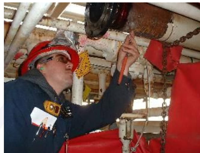
Visual Testing su tubazioni – cortesia T.C.Inspection.inc
