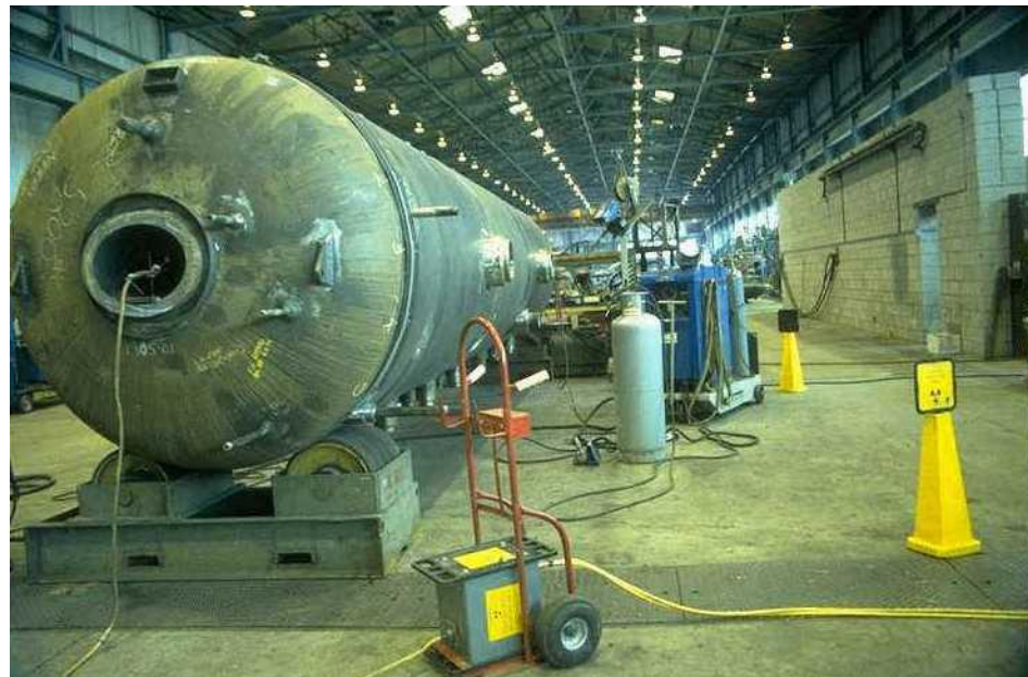
Fasi del controllo RT di un apparecchio in pressione
