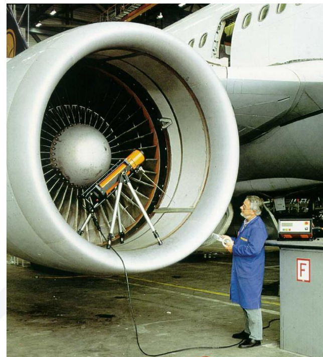
Esecuzione di un controllo radiografico nel settore aeronautico
