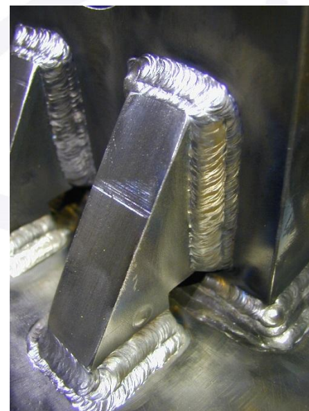
Illuminamento non sufficientemente distribuito su giunto saldato in TIG
